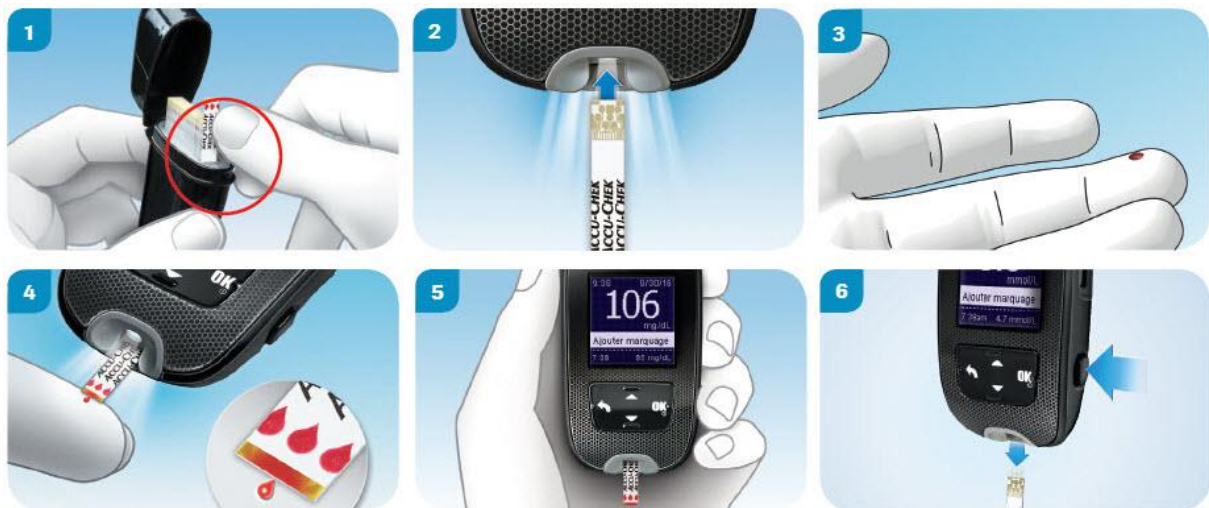
Figure 45: Fonctionnement du lecteur glycémique(23)
