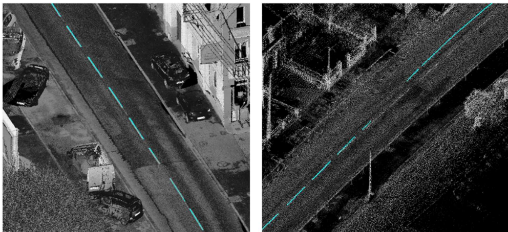
Figure 9 : Vectorisation réussie (à gauche) et mauvaise vectorisation (à droite) issues de l’outil “Extraction by intensity” de Topodot
