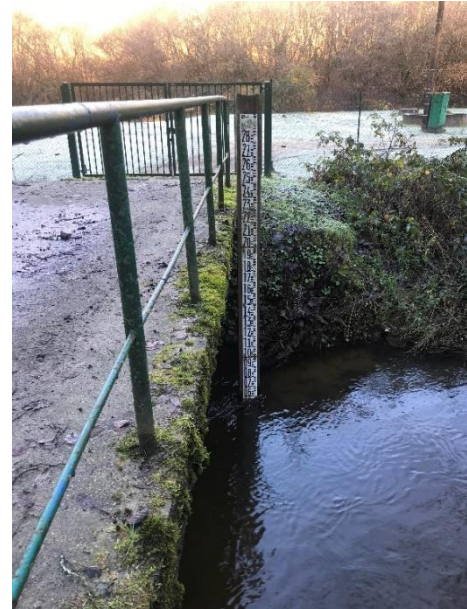
Figure 16: Photographie d'une échelle limnimétrique, Belle-Isle-en-Terre, décembre 2019. Source : M.Guillemois.
