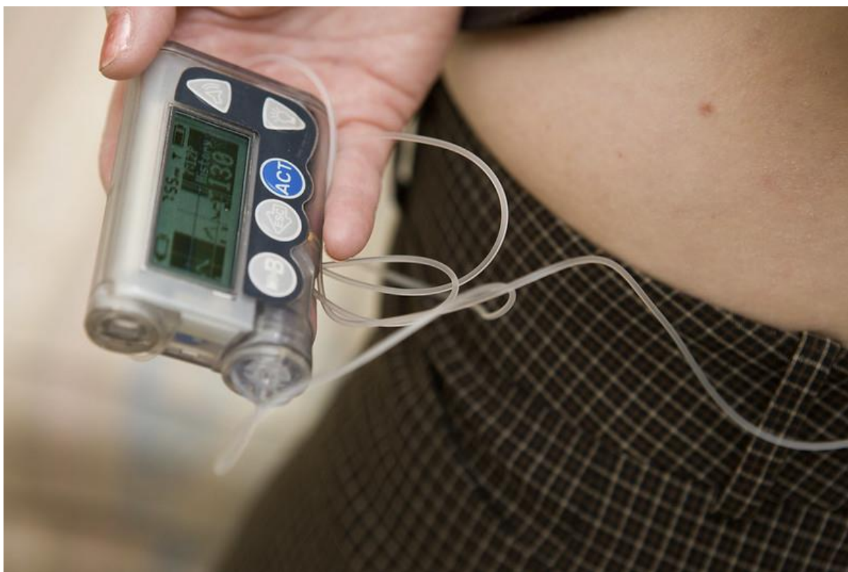
Figure 7: Photo d'une pompe à insuline externe
