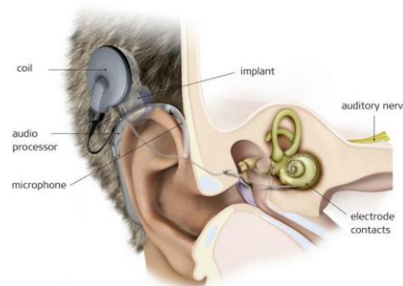
Figure 1 Les composants de l'implant cochléaire
