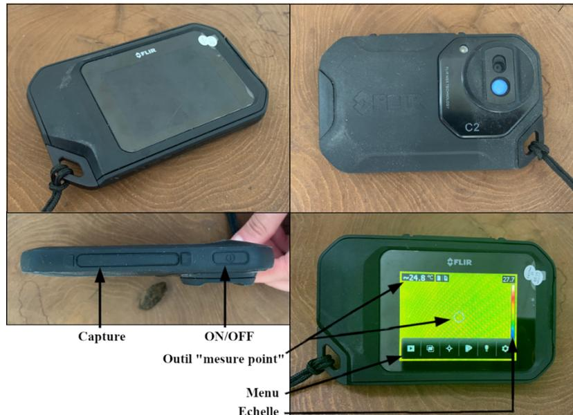
Figure 14 : Présentation de l'appareil de photographie numérique infrarouge C2 de Flir et de son interface.
