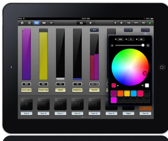
*Figure 39: L'application Luminair permet de piloter à distances certains projecteurs LED. Tout est modulable : niveau, température de couleur, teinte, saturation. © Image Credit Luminair*
