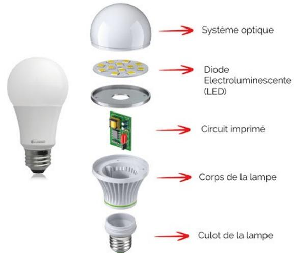
Figure 2: Schéma d'une ampoule domestique en LED © Image credit Elumino
