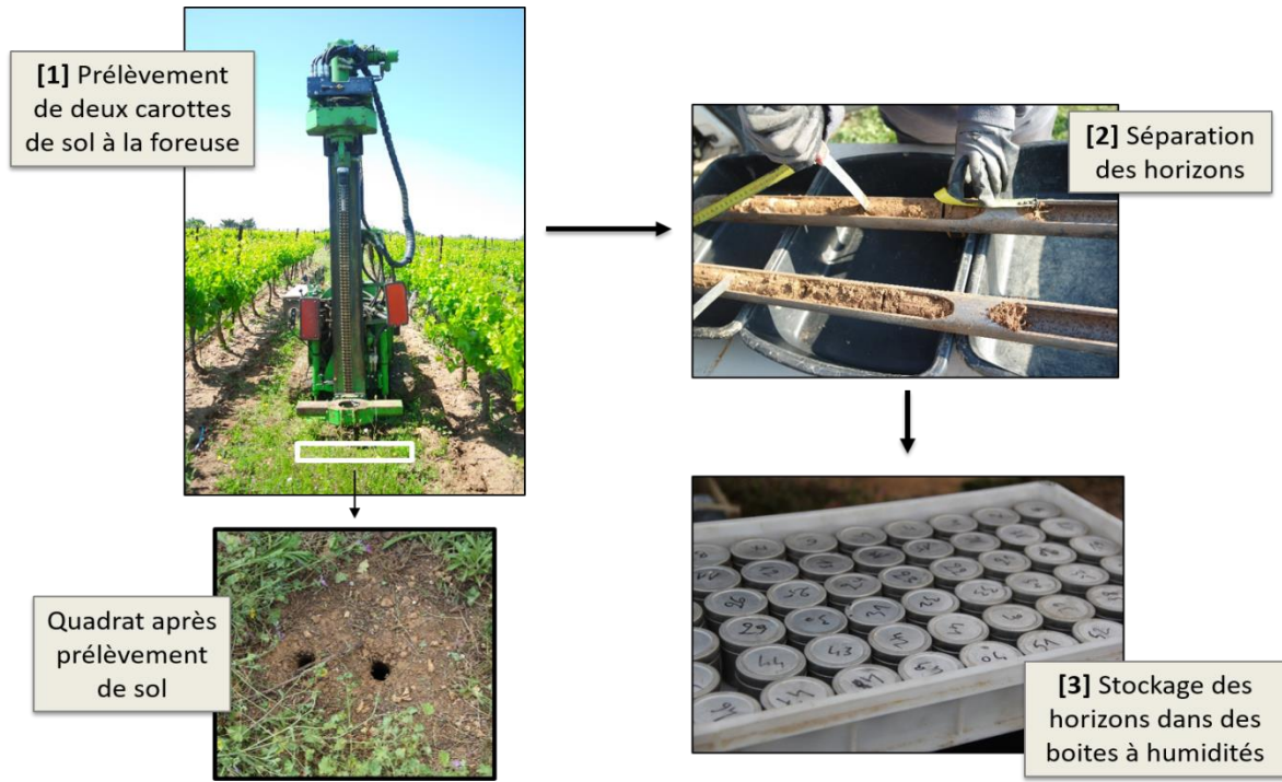
Figure 14 Les trois étapes du prélèvement de carottes de sol. Deux carottes de sol sont prélevées à la foreuse. Les horizons 0-10cm, 10-20cm, 20-40cm, 40-60cm, 60-100cm sont ensuite séparés puis stockés dans des boîtes à humidité.
