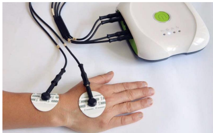
Figure 8 : Photographie de l'utilisation de l'impédancemètre Bioparhom
