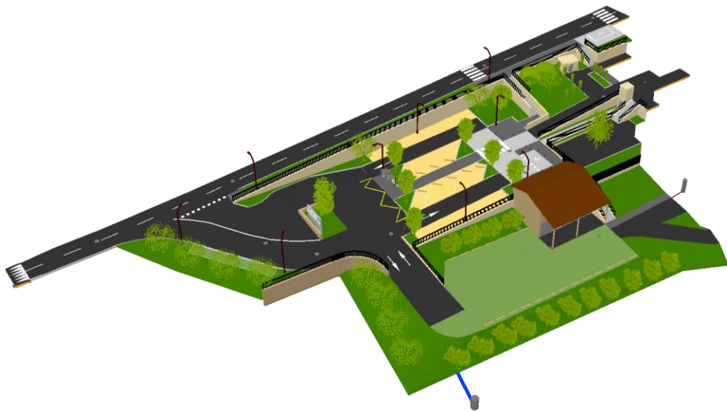
Figure 14 : Maquette assemblée au format IFC
