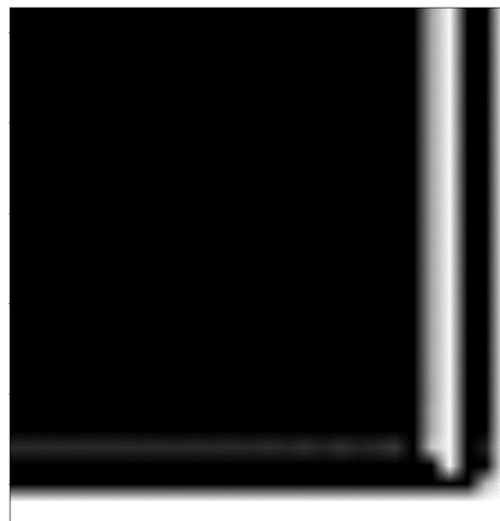
Figure 24 : Effet de bord constaté sur le raster utilisé pour générer le spectre de vague après utilisation de l'algorithme RL
