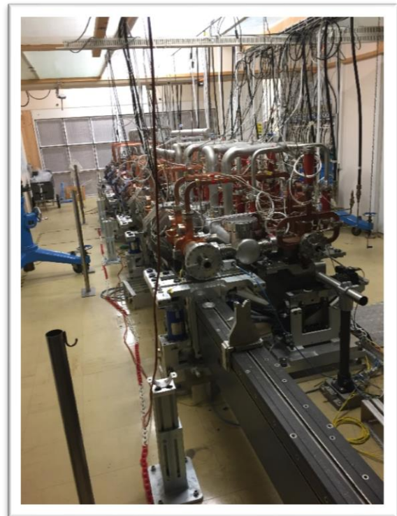
Figure 2 : Photo d'une maquette de quatre modules du CLIC
