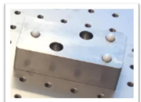
Figure 47 : Photo d'une interface trois billes classiques des capteurs de références sans système de maintien (banc Invar)
