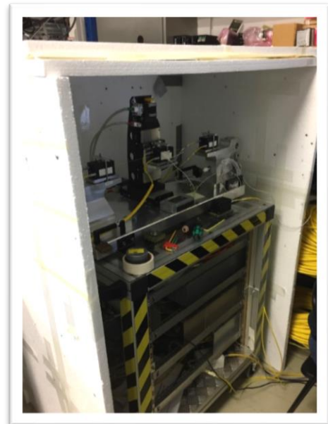
Figure 18 : Photo du caisson en polystyrène construit autour du banc de calibration mobile
