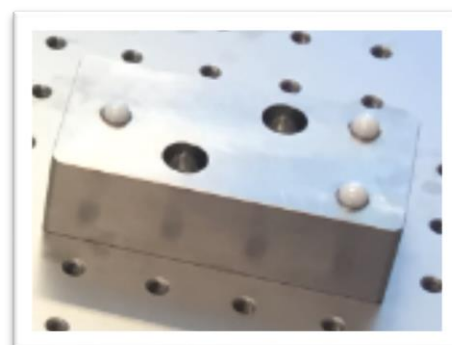
Figure 47 : Photo d'une interface trois billes classiques des capteurs de références sans système de maintien (banc Invar)
