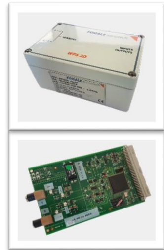
Figure 8 : Photos de deux électroniques : en haut l'électronique de Fogale Nanotech ; en bas le prototype développé par le CERN
