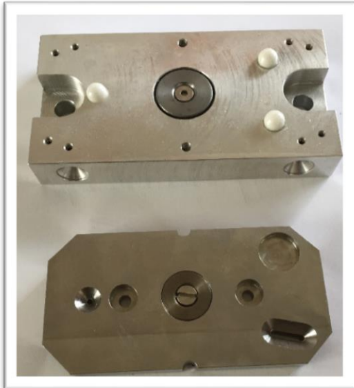
Figure 5 : Photo du système de centrage : en haut, l'interface trois billes ; en bas l'interface trait-point-plan
