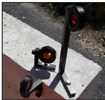
Figure n°9 : Photographie de l'installation d'un triplet de prismes.
