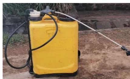
Figure 13: Photo du pulvérisateur à dos de 16 L du Fabricant Inter. Source : Youssouf
