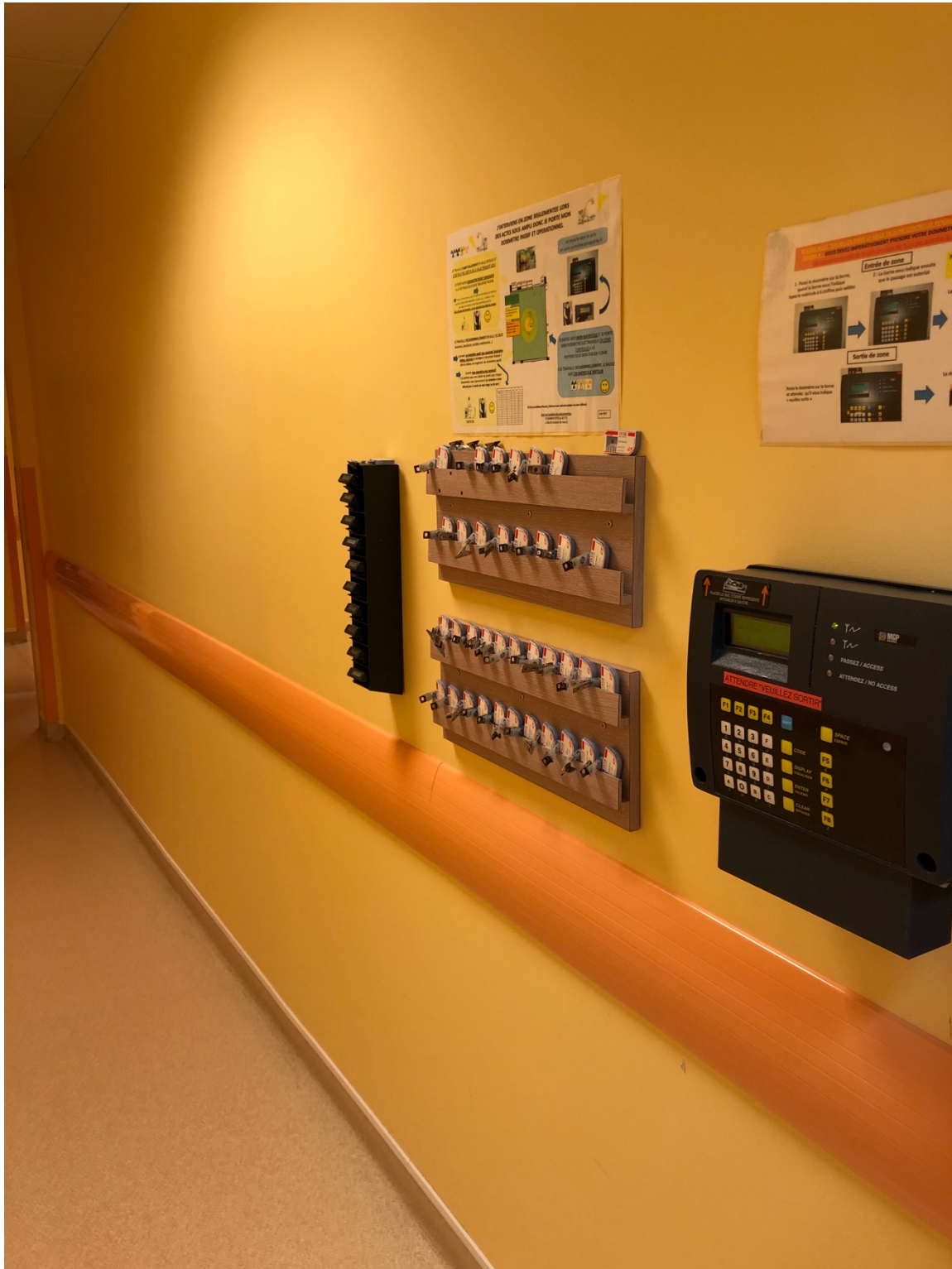
Figure 24 : tableaux des dosimètres passifs et opérationnels visibles à la sortie du vestiaire homme
