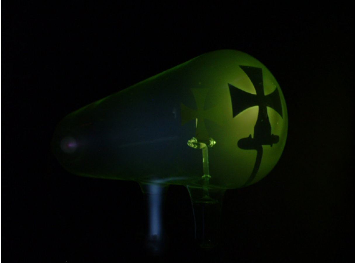
Figure 3 : l'arrivée des rayons cathodiques sur la paroi du tube provoque la fluorescence du verre, la croix de Malte fait obstacle à ces rayons, dessinant l'ombre sur la paroi du tube.
