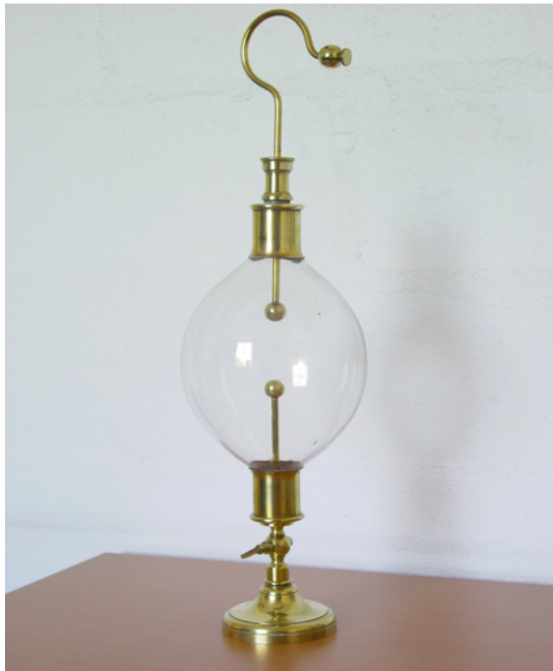
Figure 1 : appareil de Faraday pour étudier les décharges électriques dans les gaz.
