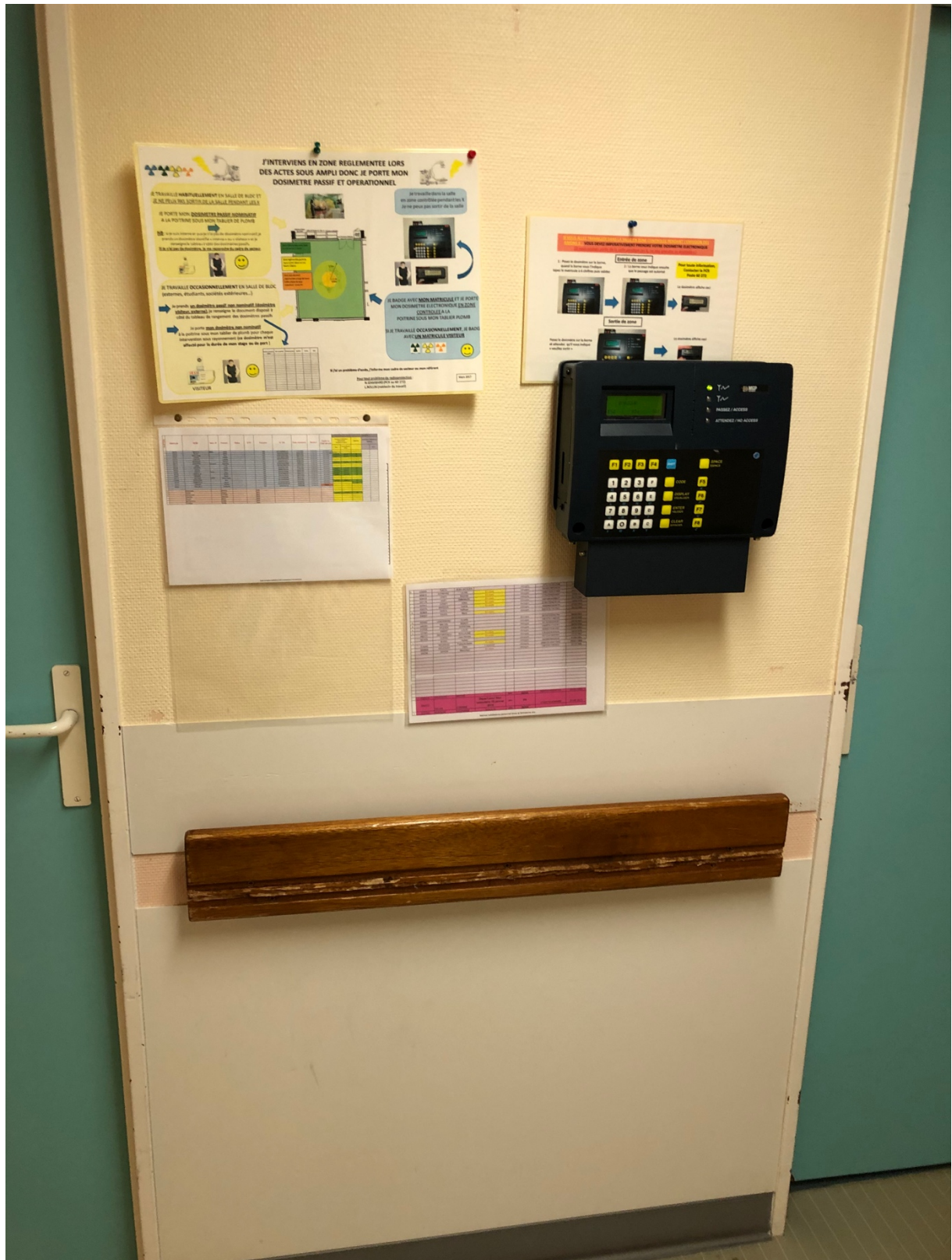
Figure 31 : information et borne d'activation des dosimètres opérationnels en amont des salles opératoires
