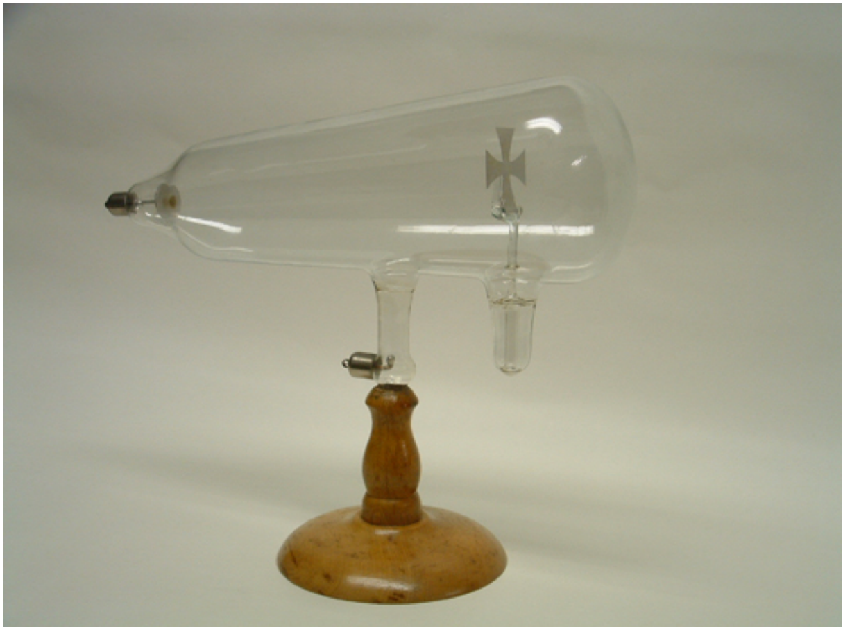
Figure 2 : cathode, anode et obstacle (croix de malte)
