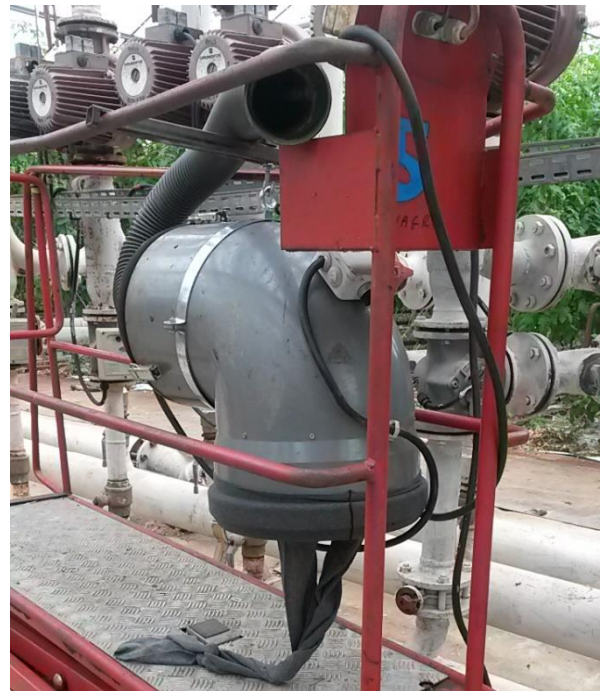
Figure 26: Aspirateur à aleurode modifié et adapté à l'aspiration de N. tenuis .
