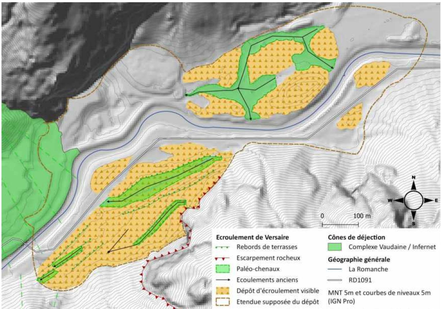
Figure 25 : Cartographie des paléo-chenaux de l'écroulement de Versaire
