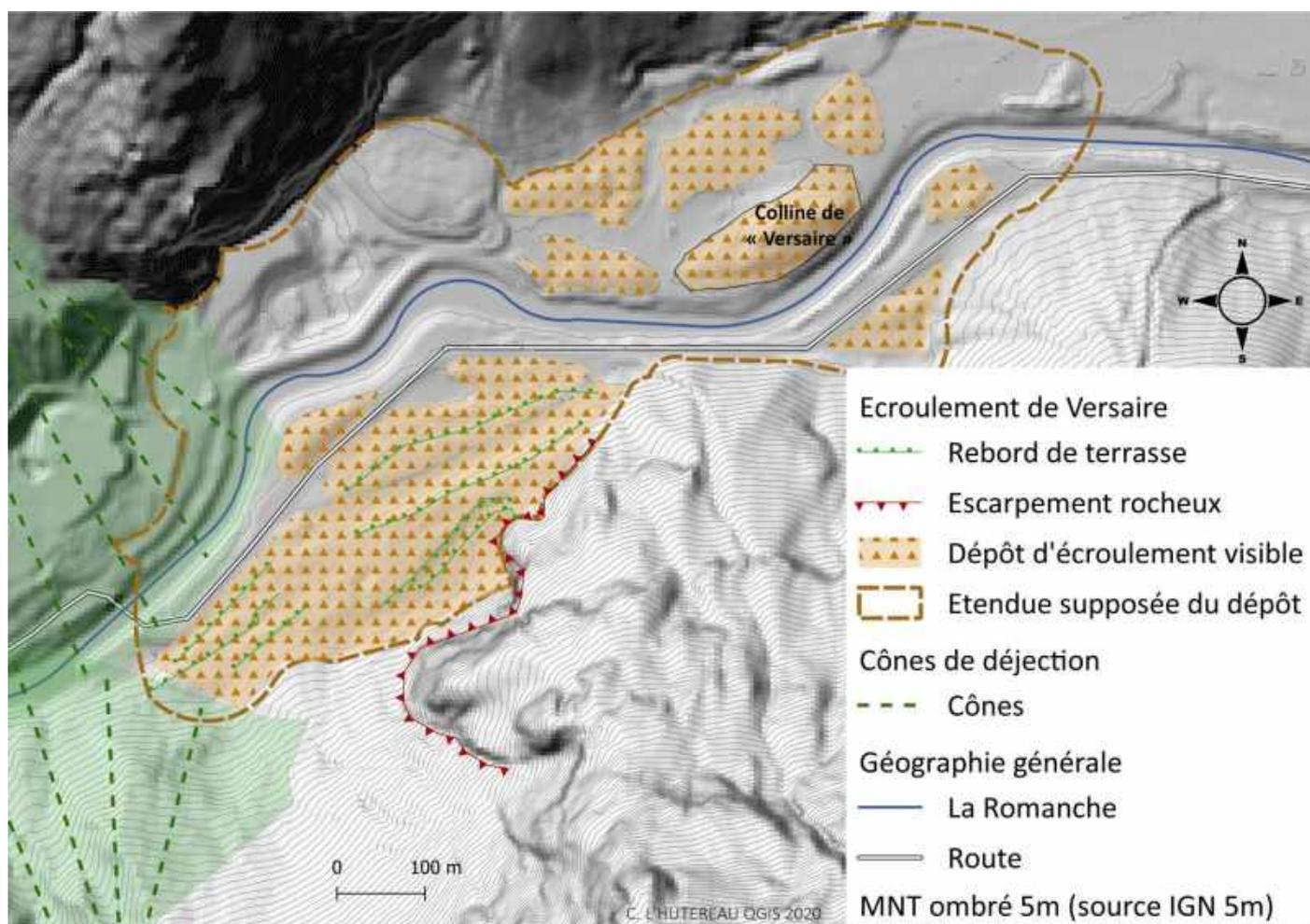
Figure 21 : Cartographie générale de l'écroulement de Versaire
