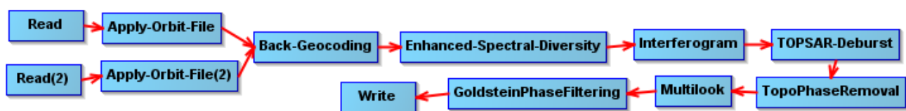
Figure 13 : Graph Builder représentant la chaîne de traitement automatisée utilisée dans cette étude pour former un interférogramme différentiel (Yan, 2003, Comm.pers.)
