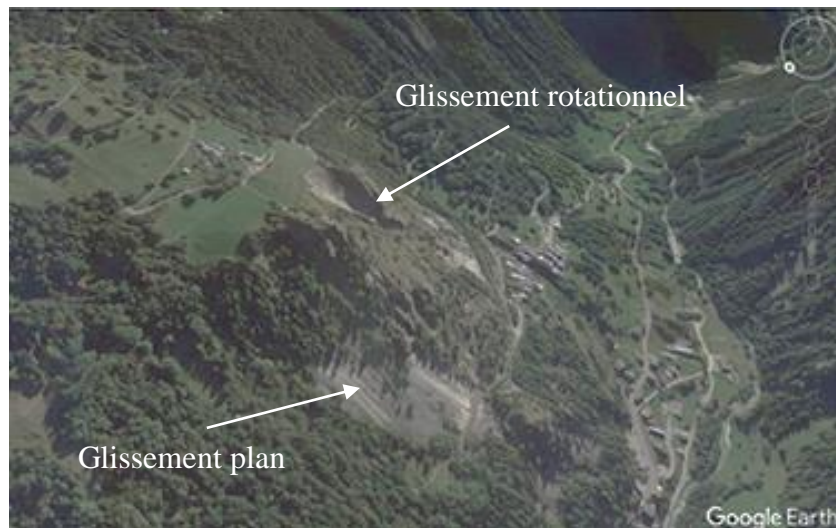
Photographie 4 : Structure typologique du mouvement de Ballandaz (Photo Google Earth, modifié par Pourrain, 2020)
