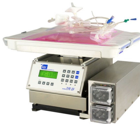
Figure 32 : Bioréacteur Wave (GE Life Systems)
