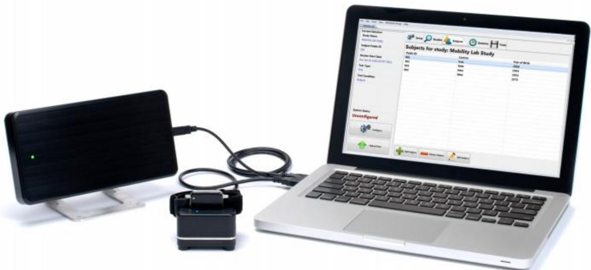
Figure 6 Mobility Lab v.1 par APDM inc., OR, USA. De gauche à droite : point d'accès, station d'accueil avec OPAL et ordinateur
