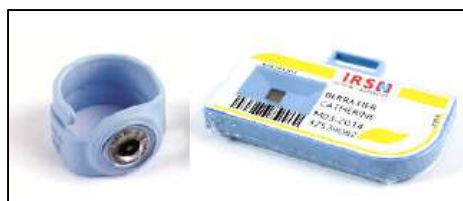
[Photographie 1] - Suivi dosimétrique passif : dosimètres bague et poitrine
