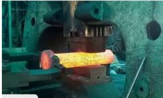
Figure 15: image d'une machine à forgé
