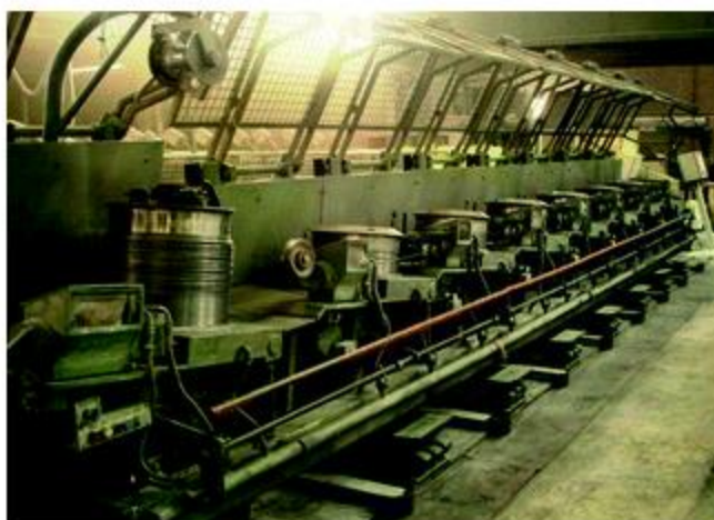
Figure 22 : Machine à tréfiler à sec. Source[LEFORT A;2010]
