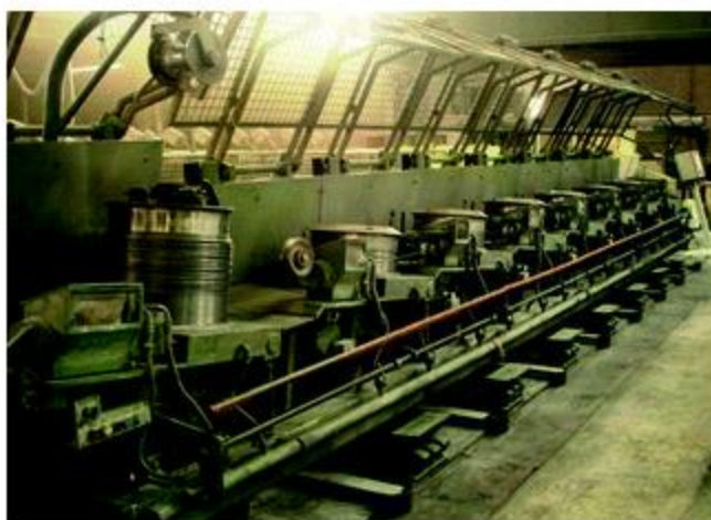
Figure 22 : Machine à tréfiler à sec. Source[LEFORT A;2010]
