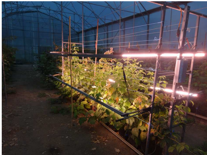
Figure 13 : Système d'éclairage LED de l'essai sur les framboises (Conthey-Suisse-, le 10 août 2020, Chambreuil T.)
