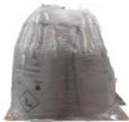
**4 - Hydroxycarbonate de nickel** : après passage dans un four, il est conditionné dans des big-bags de 700 ou 800 kg en polypropylène tissé avec une doublure en polyéthylène résistant à l'humidité.
