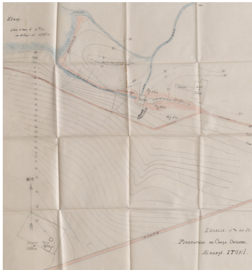
Illustration 50: Schéma de l'étang, barrage et emplacement de l'usine
