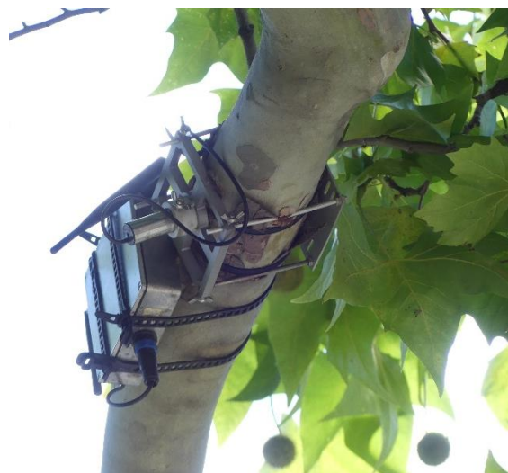
Figure 15 : Microdendromètre installé sur une charpentière de platane, rue Garibaldi, Lyon. (Photo : A. Meilleur)
