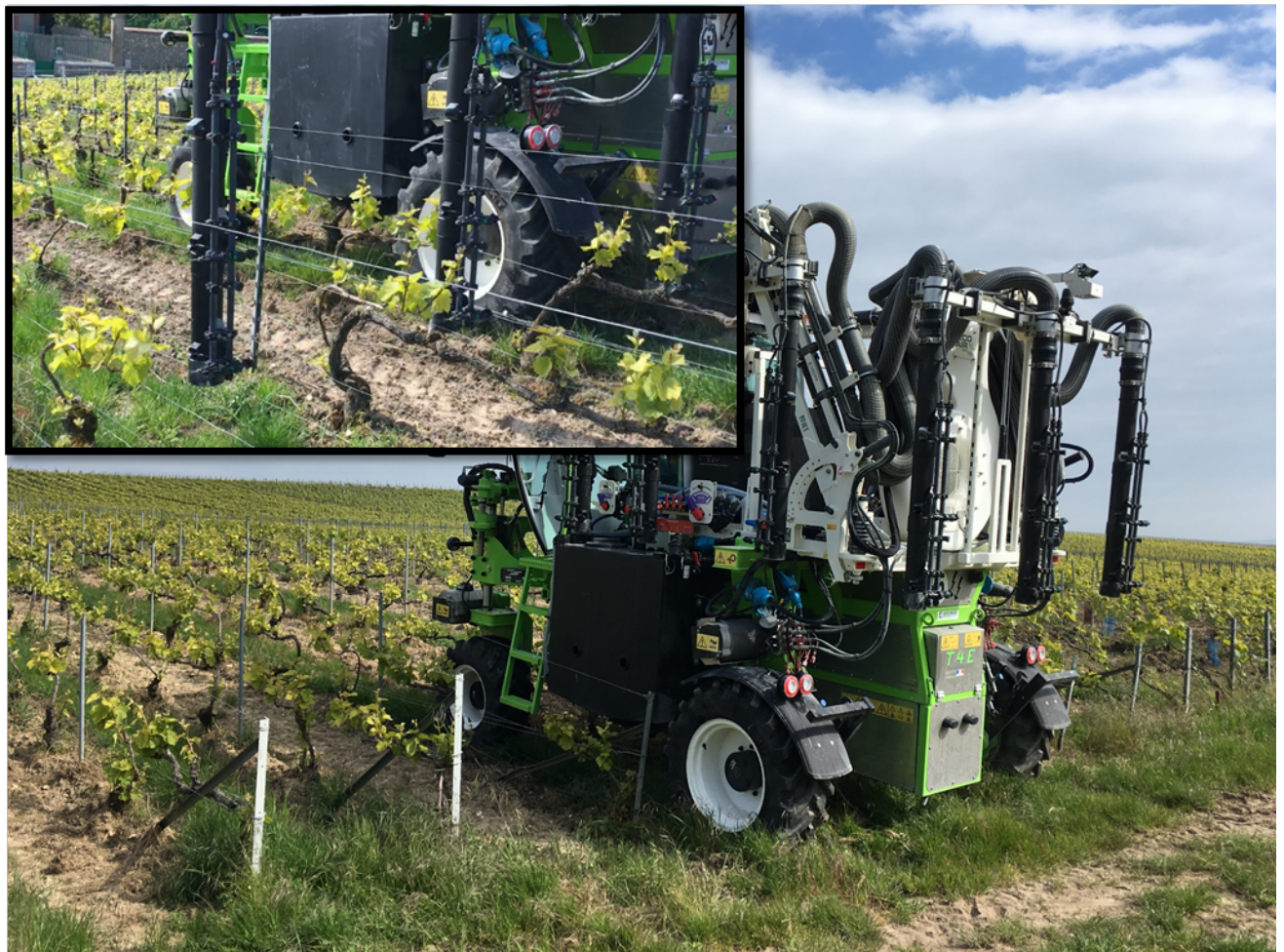
Figure 13 Pulvérisateur jet porté avec rampes descendant dans le rang (A. Herve)
