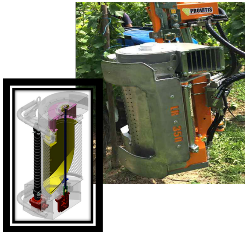
Figure 13 Effeuilleuse par aspiration type Povitis (Provitivs.com)
