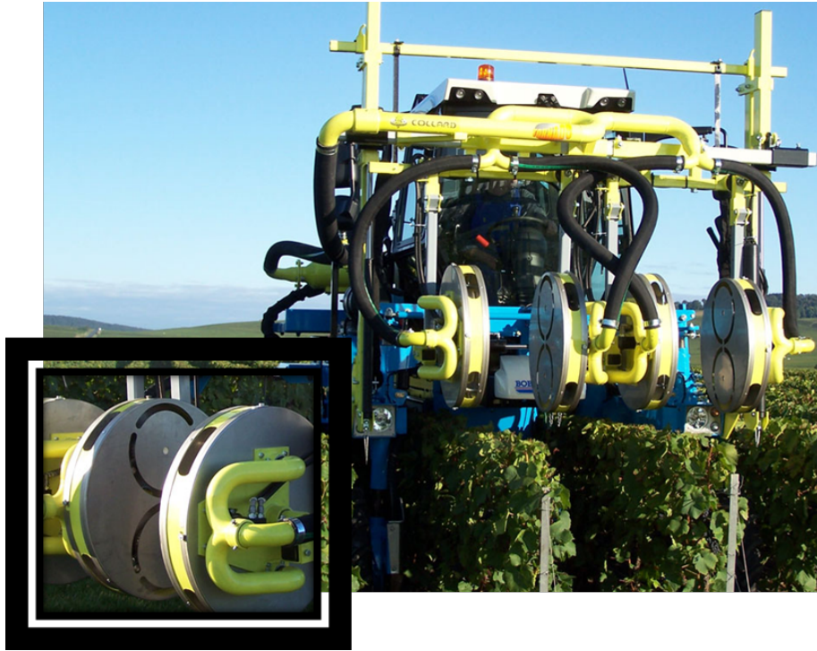
Figure 14 Effeuilleuse pneumatique Collard (Collard.com)
