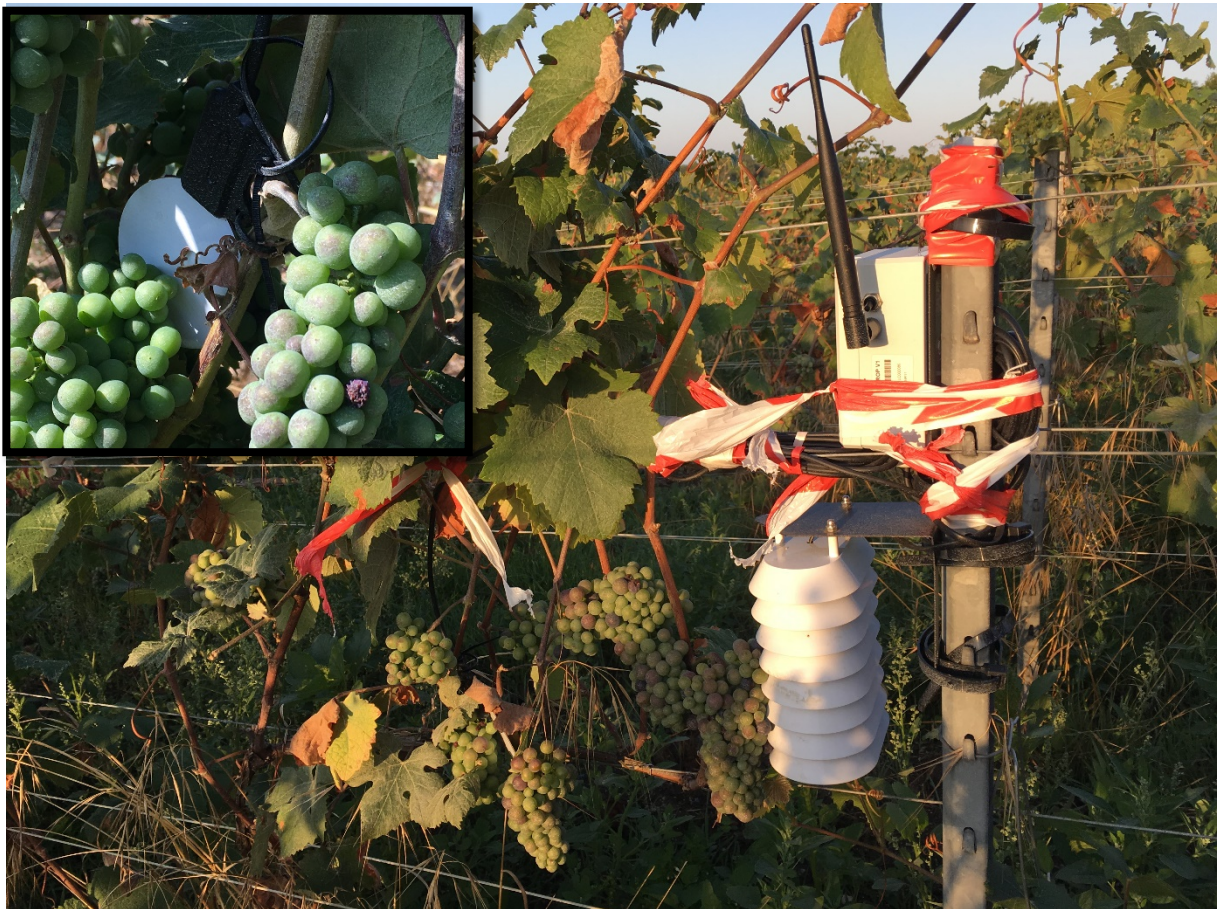
Figure 20 Exemple de positionnement de capteur Leafcrop (A.Herve, 2019)
