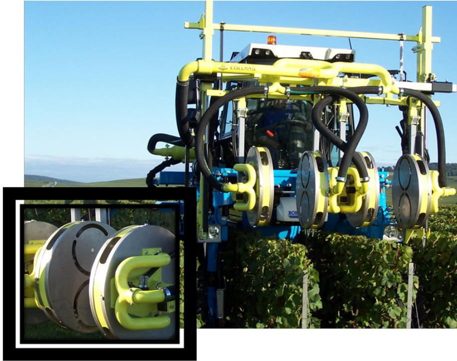
*Figure 14 Effeuilleuse pneumatique Collard (Collard.com)*
