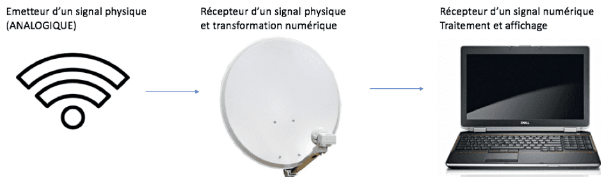
Figure 32 : Prince d'acquisition et traitement d'une donnée analogique en donnée numérique.
