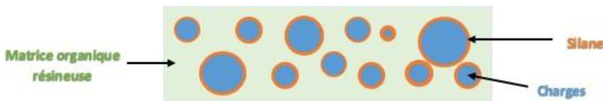
Figure 16 – Représentation schématique d'une résine composite.
