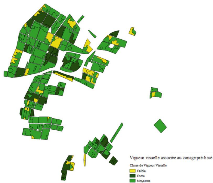
Figure 35 : Zonage pré-lissé obtenu après traitement des données par l'Aspexit (gauche) avec une moyenne de NDVI définie pour chaque parcelle (droite)
