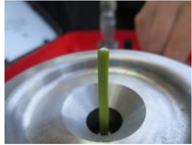
Figure 28 : Dispositif de mesure du statut hydrique de la vigne à l'aide de la chambre à pression
