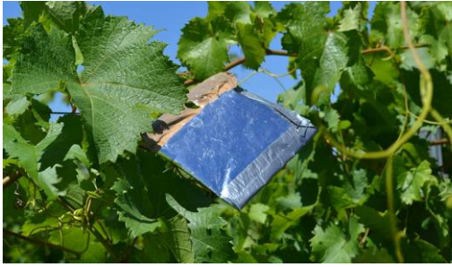
Figure 28 : Dispositif de mesure du statut hydrique de la vigne à l'aide de la chambre à pression
