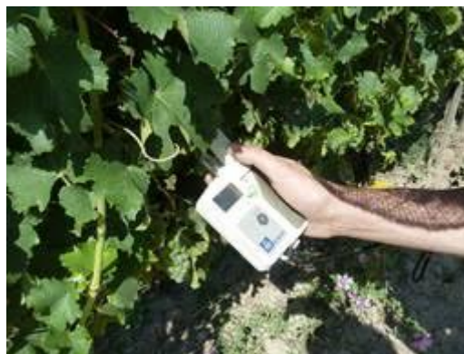
Figure 21 : Mesure avec le N-tester sur vigne
