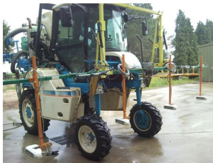
Figure 8 : Montage du dispositif sur l'enjambeur du GreenSeeker
