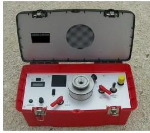
Figure 28 : Dispositif de mesure du statut hydrique de la vigne à l'aide de la chambre à pression
