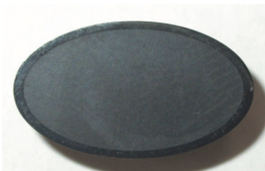
Figure 1 : vue en coupe d'un substrat de granite (gris) entouré de son revêtement de pyrocarbone (noir) [2]
