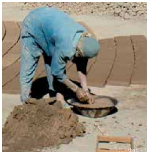
Moulage des briques (effet du geste)
