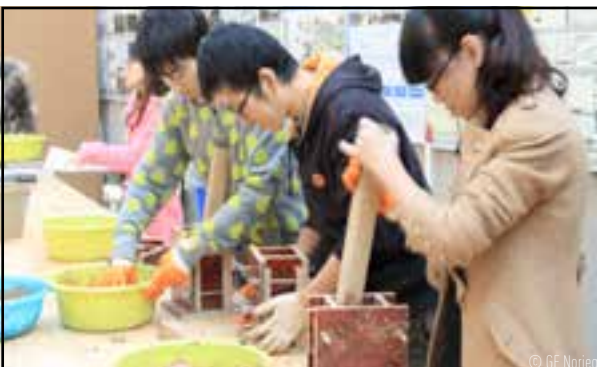
Damer l'échantillon par couches homogènes
