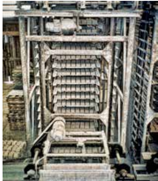
1992 machine pondeuse motorisée, fabrique Hans sumpf, Fresno Californie USA, CRAterre. Fabrique d'adobes industrialisée, Allemagne, CRAterre.
