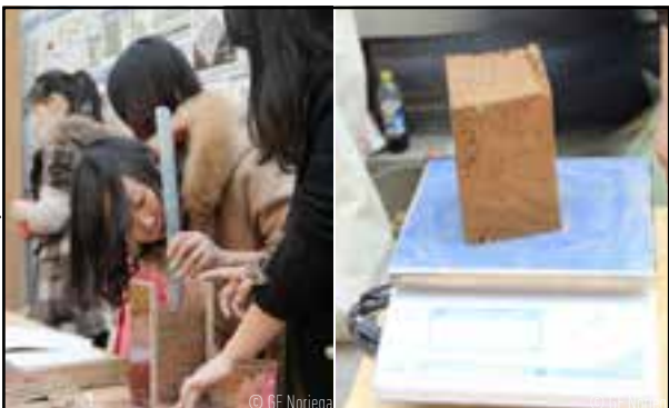
Mesurer les résultats (hauteur finale et poids humide)
