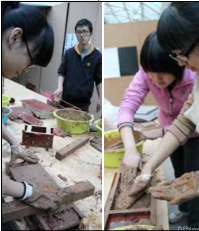
Moulage des briques
