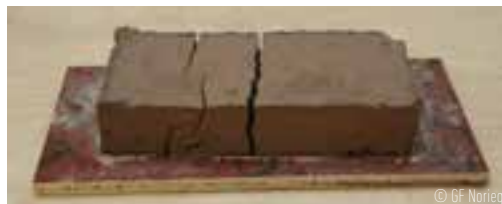
Fissuration (effet du retrait des argiles)
