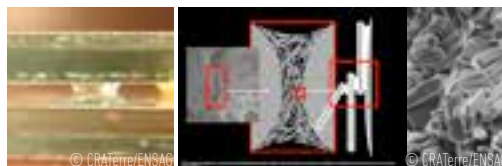
Pont capillaire (principe de cohésion des argiles)
