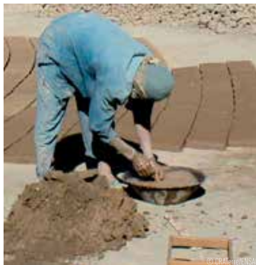
Moulage des briques (effet du geste)
