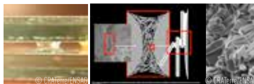
Pont capillaire (principe de cohésion des argiles)
