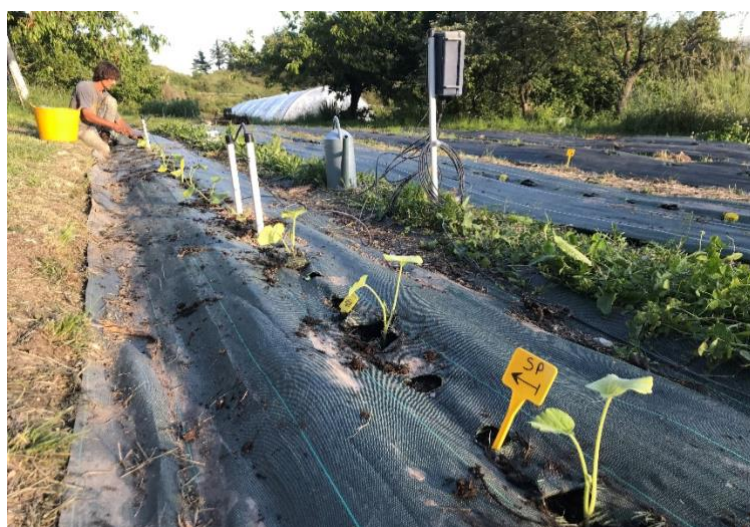
Figure 16 : Sondes tensiométriques Watermark installées, 05/06/2020
