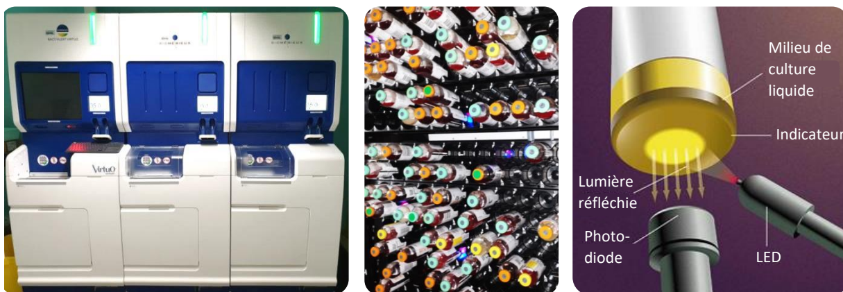
Figure 8 : photos du système BACT/ALERT® et principe de détection
