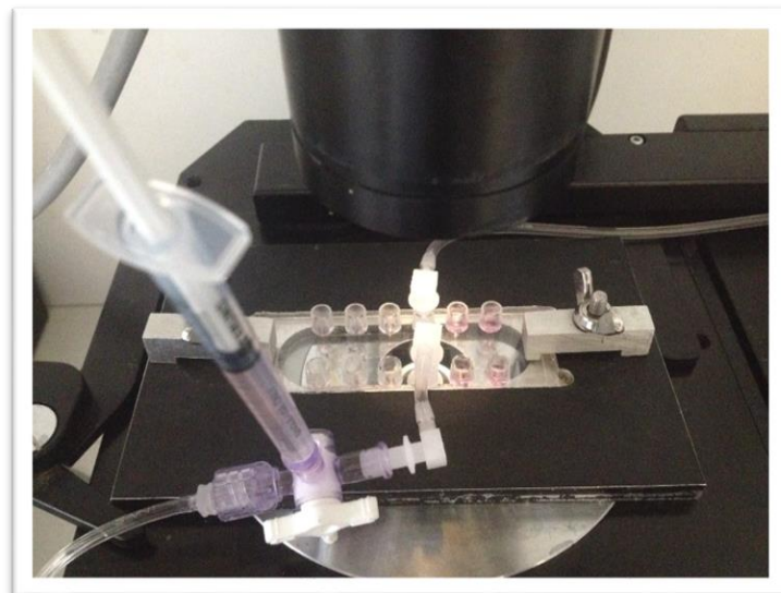
Figure 22 Chambre à flux perfusée et déposée sur la platine du microscope inversé. La seringue permet d'injecter les LTM préparés. Le flux arrive par le puit inférieur, passe dans le canal et est évacué vers la poubelle par le puit supérieur de la chambre.
