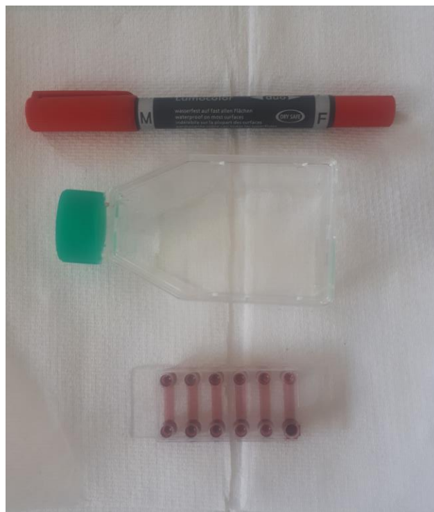
Figure 36 Différences de dimensions entre une boîte de culture cellulaire et les canaux d'une chambre à flux. Les canaux de la chambre à flux ont été colorés en rouge.
