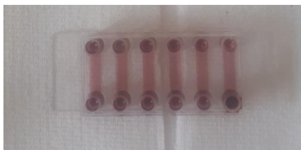
Figure 21 Chambre à flux IBIDI® \mu -Slide VI 0,4 (les canaux ont une section supérieure à ceux de la \mu -Slide VI 0,1).
