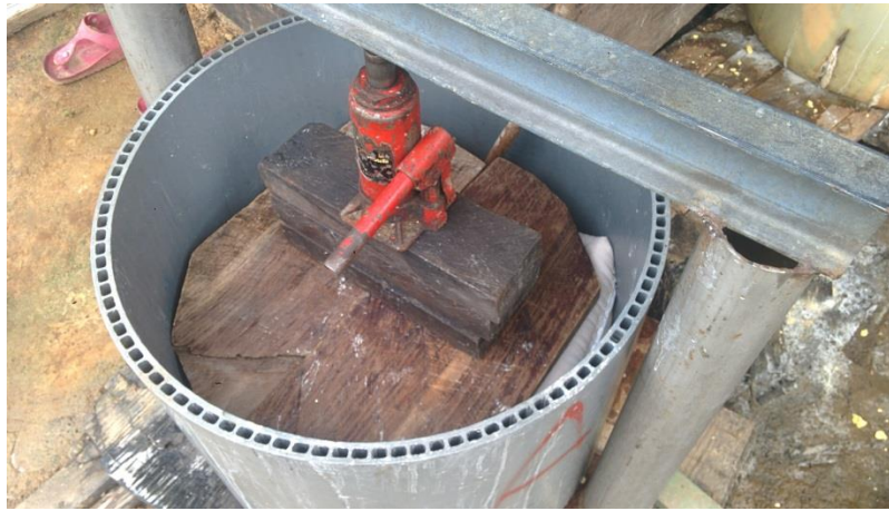
Figure 8 Presse pour l'extraction du jus (photo personnelle)
