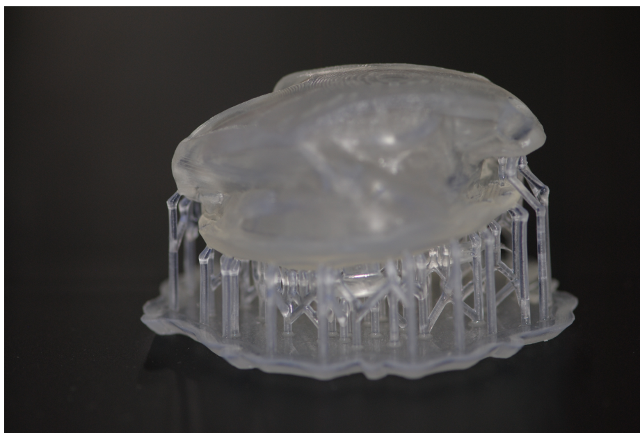
Figure 85 : obturateur après impression
