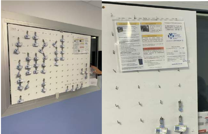
Figure 8 - Dosimètres passifs avec les instructions d'utilisation.
