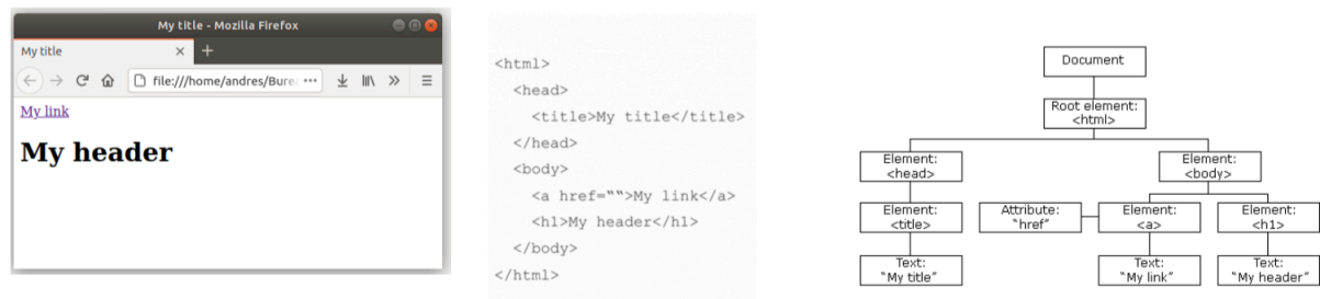
Figure 7 : une page web vue (a) dans un navigateur web, (b) dans un éditeur de texte, (c) en tant que structure hiérarchique
