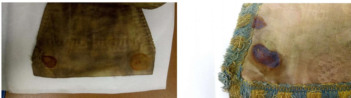
Exemples de dégâts causés par des mauvaises conditions d'exposition (attaches métalliques)
